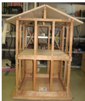
手前一面のみ耐震要素なし (平面配置バランスの実験例)
